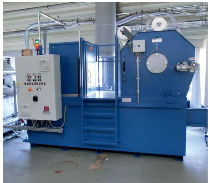
Eintauchkühler für Öl für Schleifbearbeitung
