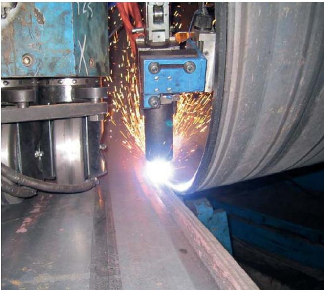
Plasmaschneiden von Stahlplatten
